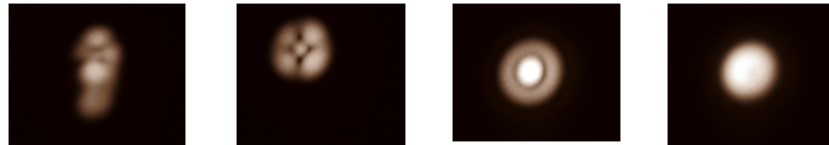
איור 33: כתמי האור שהתקבלו עבור כיפופים שונים של הסיב. צורת הכתם מעידה על אופן התנודה שיצא מהסיב.
