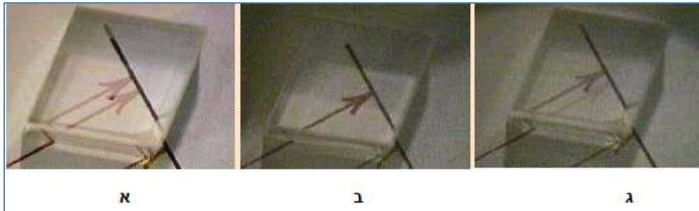
איור 11: א. במעבר דרך תווך שיוצר שבירה כפולה (גביש קלציט) האור נע בשני מסלולים בהתאם לקיטוב; ב. דרך מקטב שמוצב בכיוון המתאים עוברת רק "הקרן הרגילה"; ג. כאשר המקטב מסובב ב- 90^\circ עוברת "הקרן החריגה".
