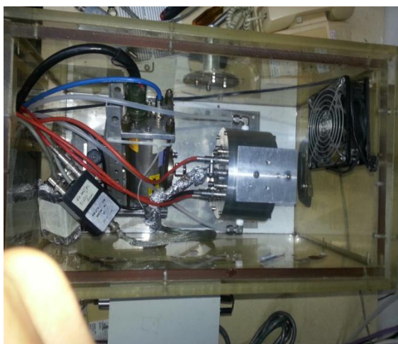
מבט מלמעלה (מצד ימין מקור הקרינה ומצד שמאל מערכת הגלאי)
